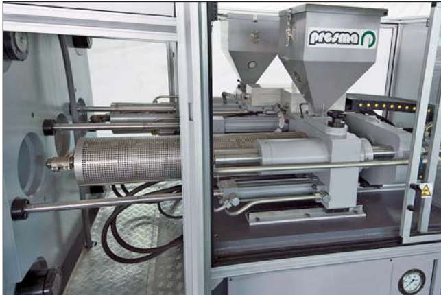
particolare zona iniezione / injection unit particular
