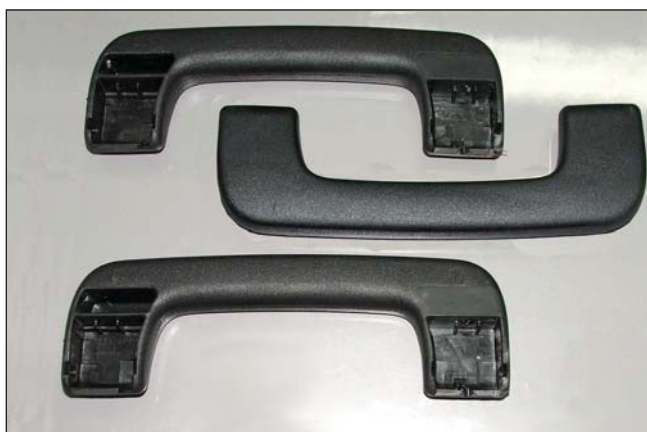
esempio pezzi prodotti / moulded pieces (TPU + PP foam)
