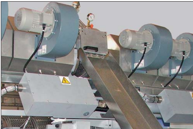
zona degasaggio e ventilatori / degassing zone and fans
