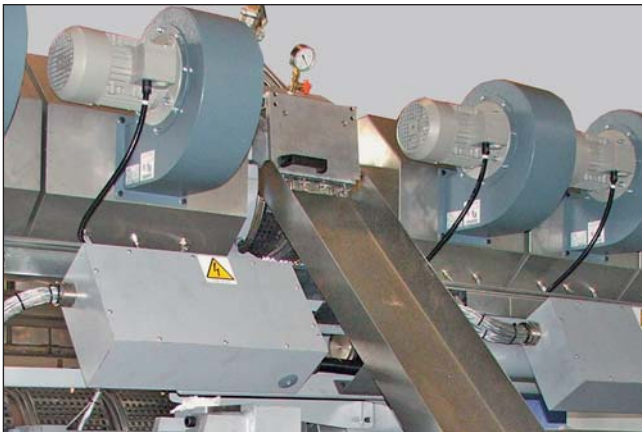
zona degassaggio e ventilatori / degassing zone and fans
